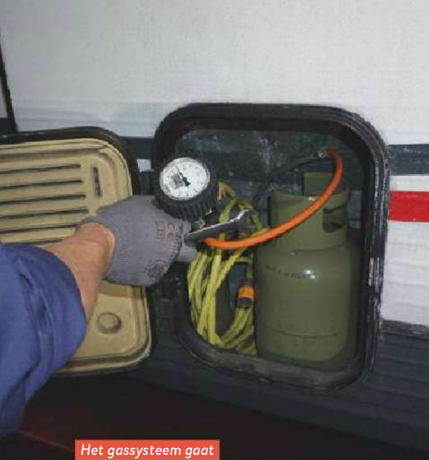
Met de zeepsopmethode is het lekje snel ontdekt.
